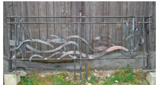
Das fertige Geländer mit Wellen, Fischen und Rohrkolben vor dem Verzinken
